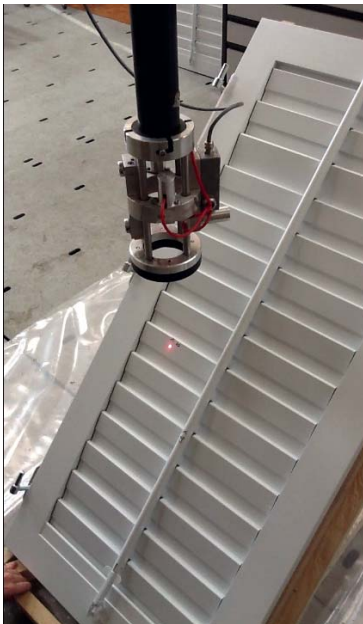
Mittels einer Hagelkanone wird der natürliche Hagel-schlag simuliert.
