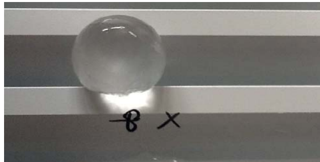
Die Aluminium-Fensterläden von Alurex Kindt widerstehen Hagelkörnern mit einem Durchmesser von 20 mm, die mit einer Geschwindigkeit von 86 km/h aufprallen.
