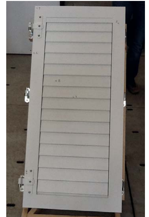
Nach dem Beschuss zeigten sich weder Dellen noch sonstige Schäden.
